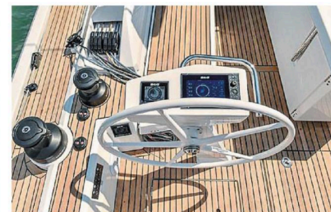
A poste. Les deux barres sont installées sur des colonnes plus élégantes que des blocs, terminées par les répéteurs bien intégrés.
